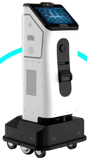
轮式智能巡检机器人
